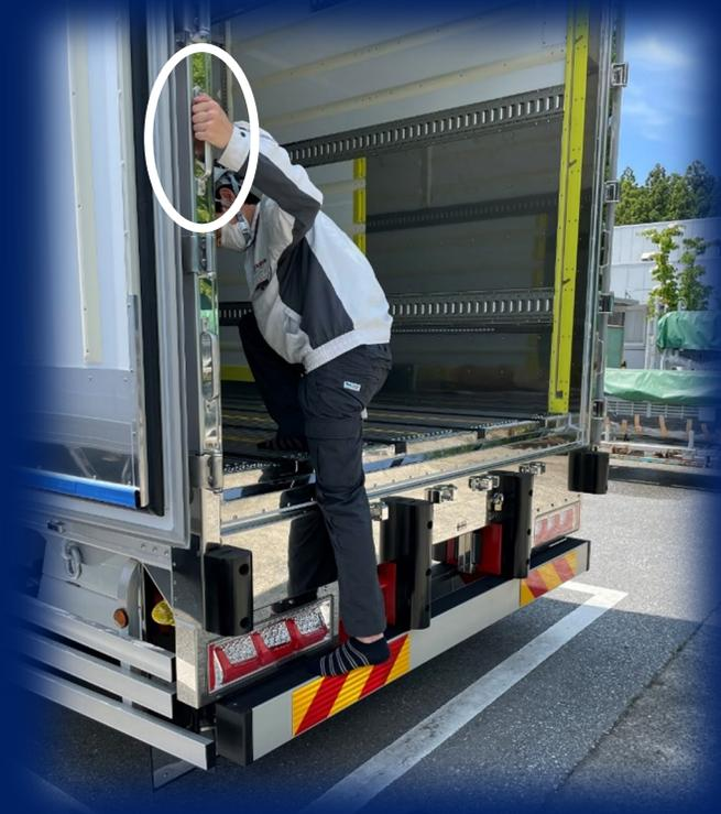
ボディ内へ昇る時は下の取手を、降りる時は上の取手を使用し昇降時の安全性を高めます。
