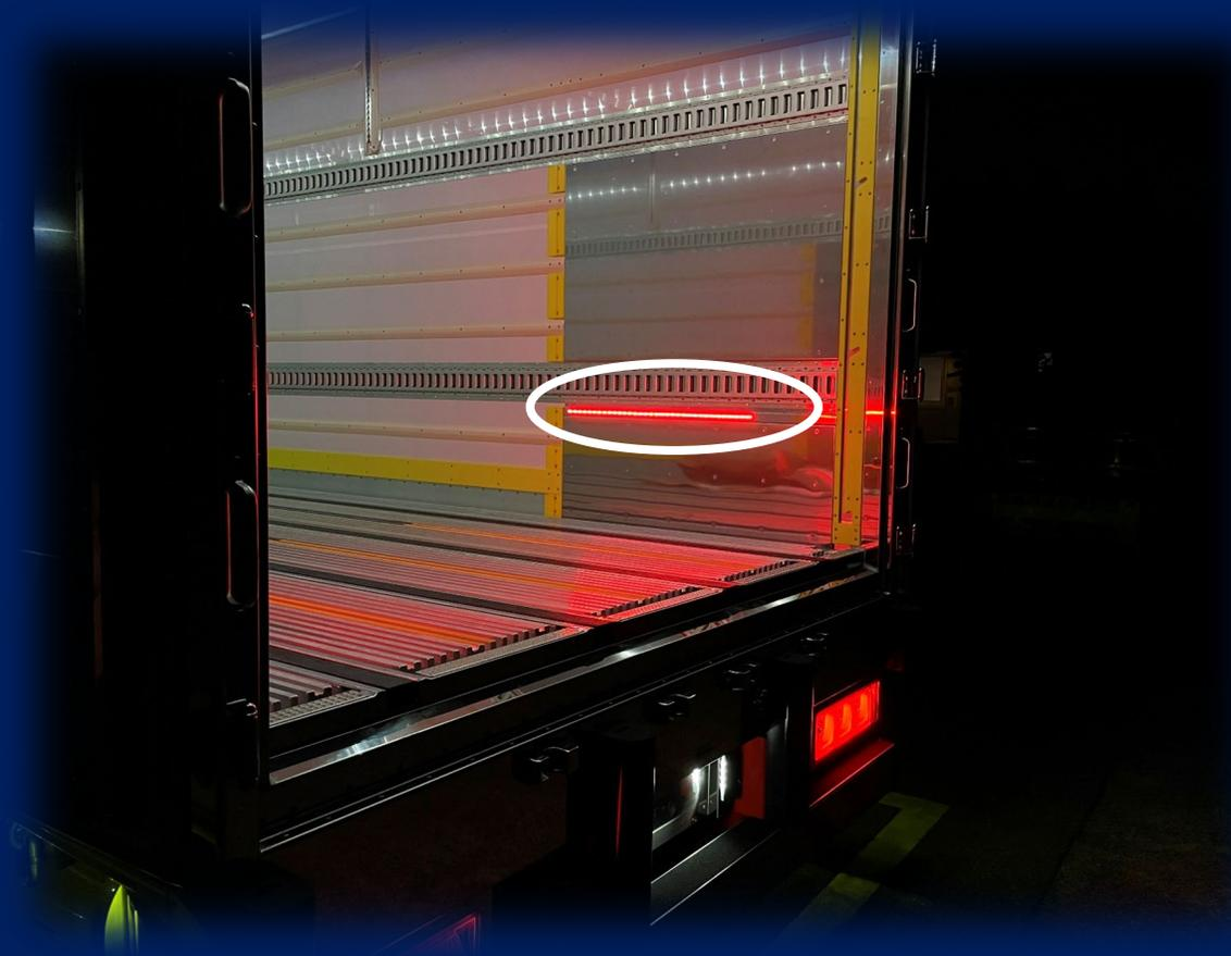
赤色LEDでボディ後端を知らせ、転落防止を図ります。
